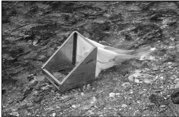
Fig. 2.1. Bentometrul de tip Surber folosit pentru prelevarea probelor de bentos din apele curgătoare de mică adîncime
