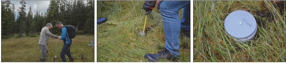
Etape de amplasare a unui piezometru la Tinovul La Poduri
