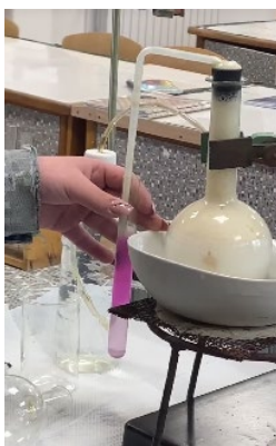
16. ábra: Az etanol előállítása a laboratóriumban
