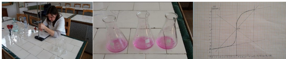
16. ábra. A kénsav oldat titrálása fenolftalein indikátor jelenlétében
