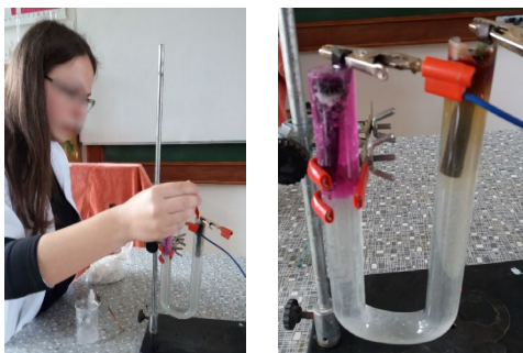
9. ábra. A NaCl oldat elektrolízise
