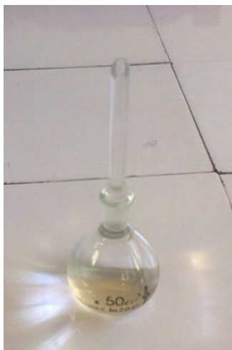
12.ábra: Piknométer az oldatok sűrűségének meghatározásához
