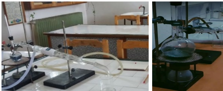
17. ábra. A kékszesz desztillációja
