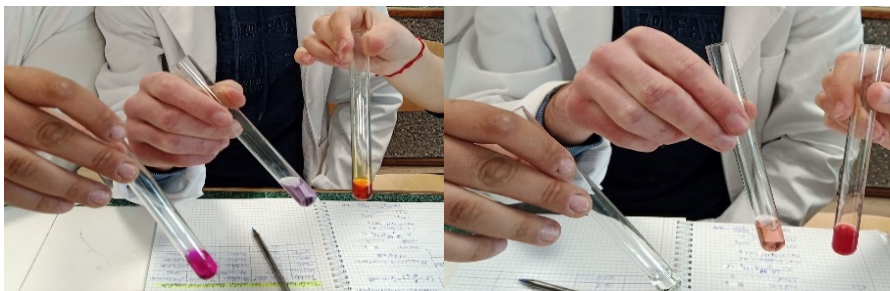
15. ábra. Vizes oldatok kémhatásának vizsgálata
