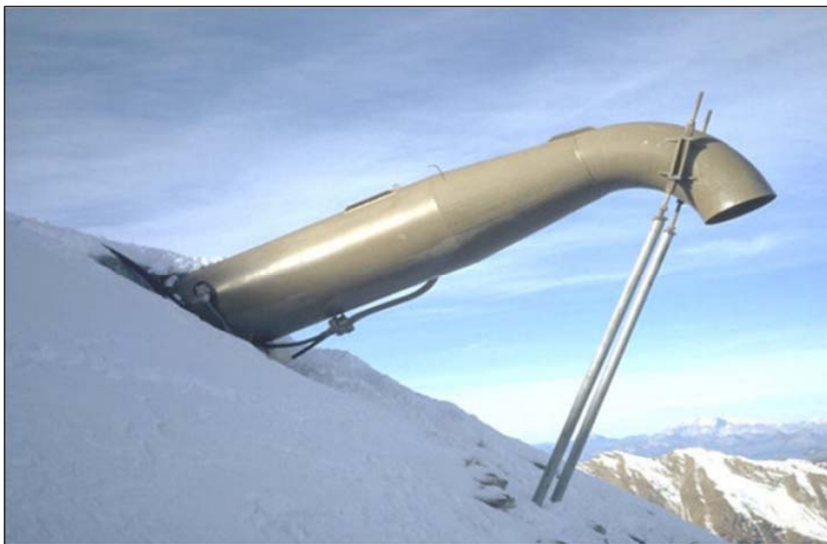
Fig. 7. 3. Tun cu gaz, de tip Gazex, pentru declanșarea dirijată a avalanșelor (Rapin, 2003, citat de Moțoiu, 2009, p. 198)
