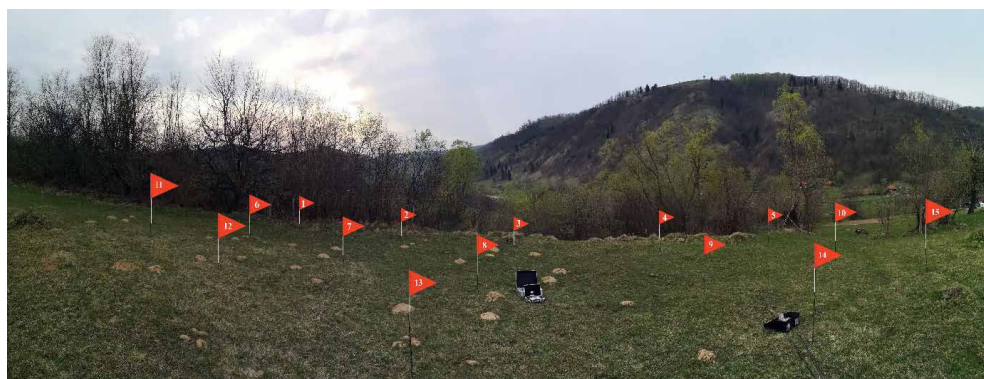
Fig. 24. Schema de măsurare a concentrației de radon și a permeabilității solului în teren
