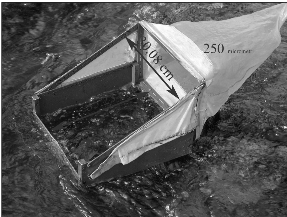
Fig. 2.46. Bentometrul de tip Surber, pentru prelevarea probelor cantitative de zoobentos din râuri
