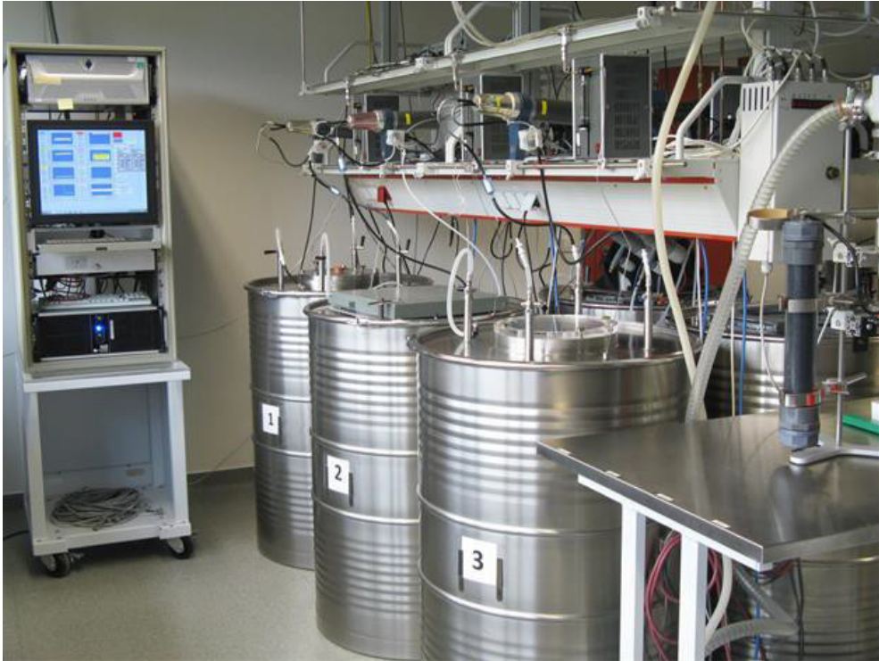
Figura 5. Laboratorul de calibrare a radonului al Biroului Federal German pentru Protecție Radiologică cu containerele de calibrare cu volumul de 0,4 m 3 (imagine preluată din Foerster et al., 2019).
